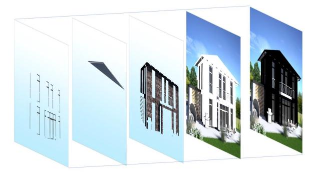
Ein Konfigurator kann aber die verschiedenen Teile in verschiedenen Bildern übereinanderlegen. Es entsteht der Eindruck eines Gesamtbildes, aber tatsächlich können Griffe und die Teile der Bauformen einzeln gerendert und überblendet werden. Sie benötigen nur noch 231 Bilder.
